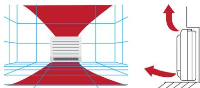
In modalità riscaldamento, il calore giunge anche a livello del pavimento garantendo una temperatura omogenea in tutto il locale. Massimo comfort assicurato.
